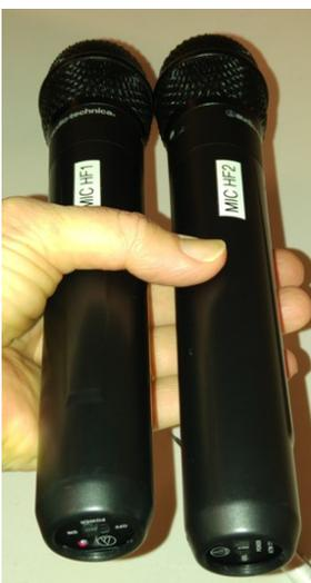
Sous chaque micro sans fil, il y a un interrupteur ON OFF voyant rouge de mise en marche et témoin état des piles se trouve à côté
